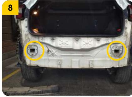
8. Aflojar todos los tornillos de anclaje del alma bumper para proceder a retirarlo.
