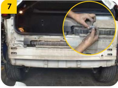
7. Desconectar con cuidado el sensor sobre el icopor para proceder a retirar el cuerpo del icopor.
