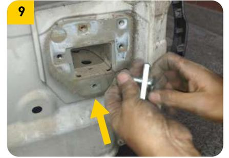
5. Utilizar las tecnica de pescas para insertar los tornillos de anclaje (F) dentro del chasis del vehiculo a traves de los canales descubiertos al retirar el chasis.
