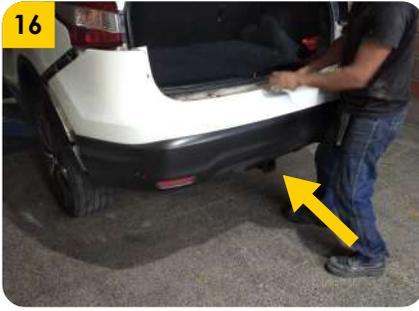
16. Ubicar nuevamente el bumper plastico con todos sus puntos de anclaje.
