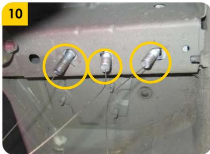
10. Realizar la tecnica de pesca y colocar los tornillos de carriage (F) dentro del chasis con sus respectivas platinas (G) y pescas(H).
