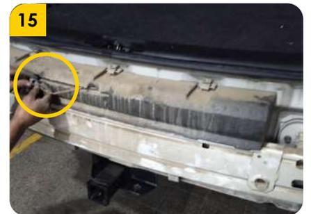
15. Posicionar nuevamente el cuerpo de icopor sobre el alma bumper y conectar nuevamente el sensor.
