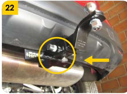
22. Colocar el Porta bola (B), asegurar con pasador (C) y pin de seguridad (D), y apretar firmemente la bola.
