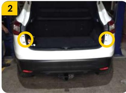
2. Retirar los 4 tornillos principales de ensamblaje del bumper ubicados en la zona central.
