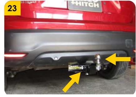
23. Para evitar vibraciones en el Porta bola (B) fijar el tornillo (prisionero E) a la tuerca ubicada en la parte inferior del tiro de arrastre.
