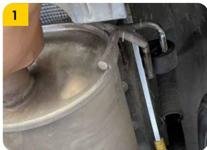
1. Retirar los cauchos de sujeción del tanque del exhosto para que baje y permita realizar el proceso de instalación.
