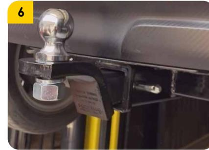
6. Proceder a ubicar el portabola (B), apretar la bola (C) y ubicar el pasador (D) y pin (E), el tornillo (F) se debe apretar levemente.
