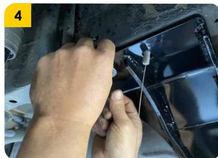
4. Retirar las pescas (L) con la precaución de que ingresen los elementos al interior de la carrocería y proceder a realizar la ubicación de arandelas (K) y tuercas (J).
