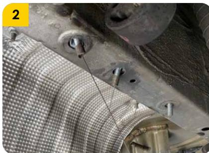
2. Realizar el proceso de técnica de pesca ingresando los elementos respectivos como los tornillos (G y H), Platinas (I) y pescas (L).
