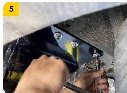
5. Apretar los elementos de sujeción del tiro de arrastre y luego ubicar el tanque del exhosto en su posición original.
