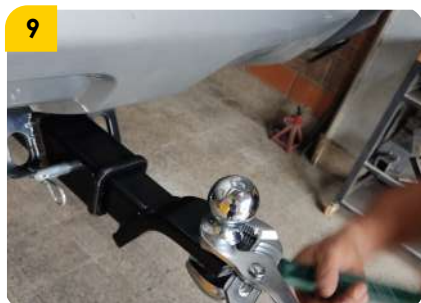
9. Instalar portabola, pasador, pin de seguridad y tornillo prisionero.
