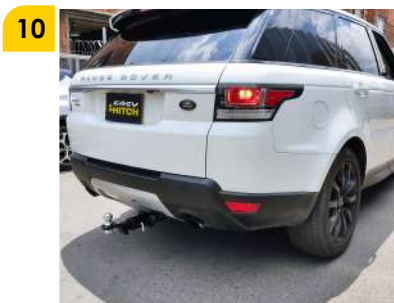
10. Tiro de arrastre instalado.
