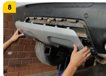
8. Instalar la tapa del bumper color gris claro.
