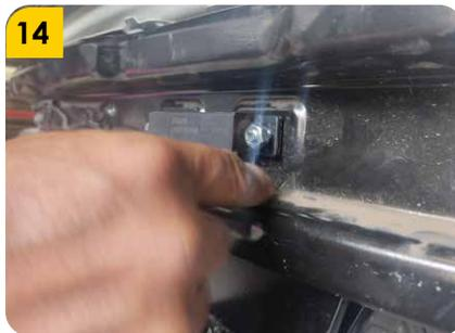
14. Reinstalar el sensor haciendo uso de los tornillos (I) y las tuercas (J).
