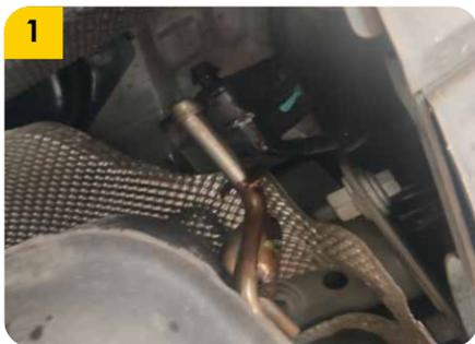
1. Realizar la desconexión del caucho trasero de cada tanque del exhausto.
