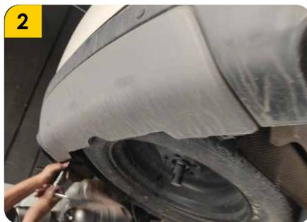
2. Retirar los elementos de sujeción inferiores del bumper y de la tapa plástica central del bumper.
