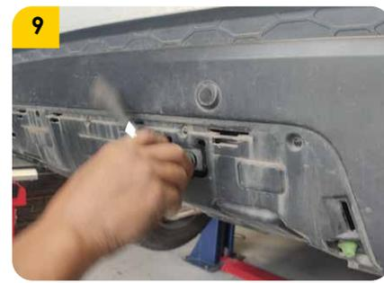
9. Desacoplar los demás elementos de sujeción del bumper que aparecen visibles luego de retirar la tapa plástica.
