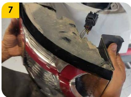
7. Despinar las luces traseras y realizar la desconexión del ramal de cables asociado a cada luz.
