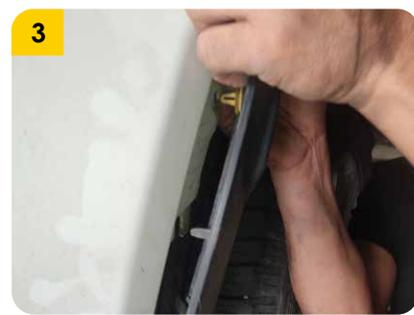
3. Retirar los biselados plásticos de ambos guardabarros con la precaución de evitar que un acople rápido se dañe.
