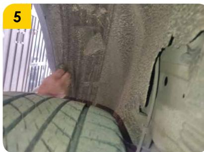
5. Retirar los elementos de sujeción de ambos guardabarros.
