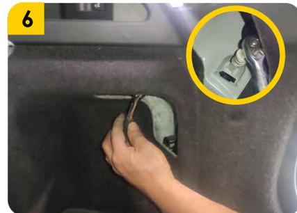
6. Mover la alfombra de la maleta de forma tal que se permita retirar las tuercas de sujeción de las luces traseras del vehículo.
