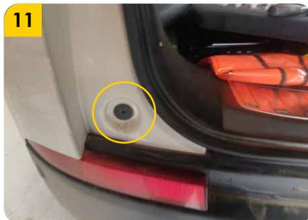
11. Retirar los tornillos de sujeción del bumper.
