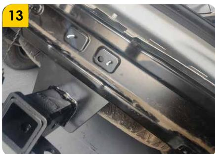
13. Ubicar el tiro de arrastres y realizar el apriete de la tornillería. Ubicar los tornillos (I) para la sujeción del sensor central.
