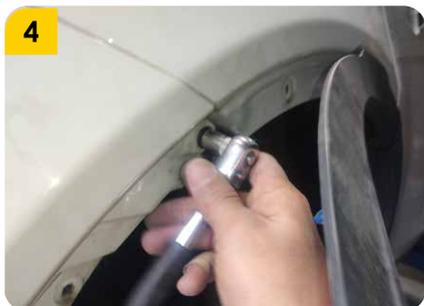
4. Retirar los tornillos de acople que aparecen luego de retirar los biselados plásticos de los guardabarros.
