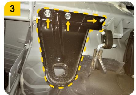
3. Retirar el **gancho** del **chasis** señalado en la imagen (de esas perforaciones se va a anclar el **tiro de arrastre**).
