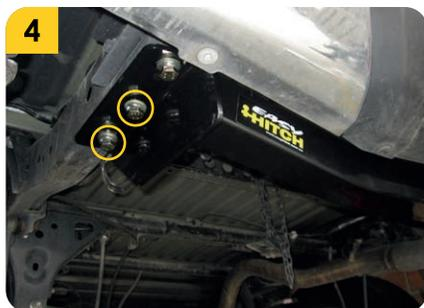
4. Colocar los tornillos inferiores (**F**) a ambos lados sin apretar, con sus respectivas arandelas (**H**) y guasas (**G**), para unir el **tiro de arrastre** con el **chasis**.
