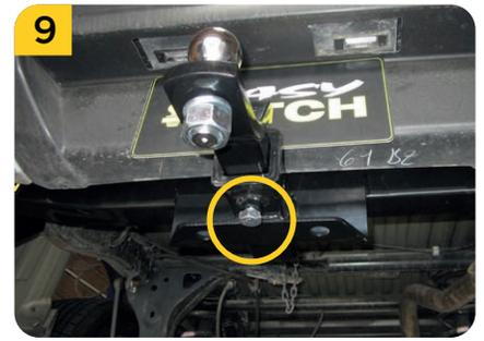
9. Para evitar vibraciones en el Porta bola (**B**) fijar el tornillo (**prisionero E**) a la tuerca ubicada en la parte inferior del tiro de arrastre.
