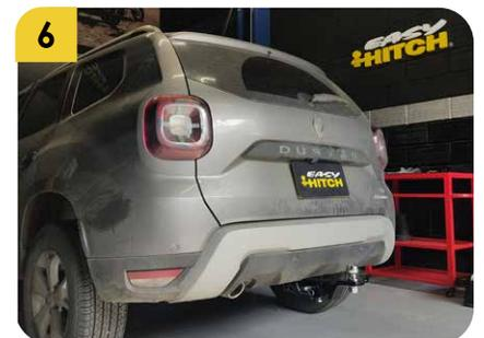
6. Ubicar el portabola (**B**), pasador (**D**), pin de seguridad (**E**) y apretar la bola (**B**) y el tornillo prisionero (**F**), este último levemente para evitar vibraciones en el portabola (**B**).
