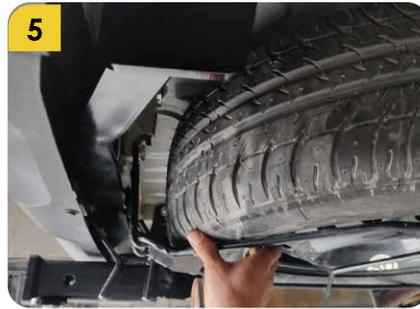
5. Reinstalar el repuesto de la llanta.
