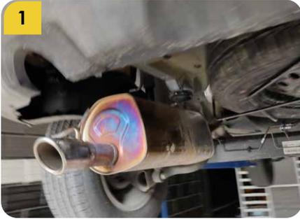
1. Retirar los soportes del mofle y su protector de calor, además de los adhesivos de las perforaciones de la carrocería para anclar la barra del tiro de arrastre.
