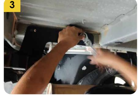
3. Proceder a fijar el tiro de arrastre con sus elementos de sujeción pertinentes, sus arandelas (**I**) y tuercas (**H**).
