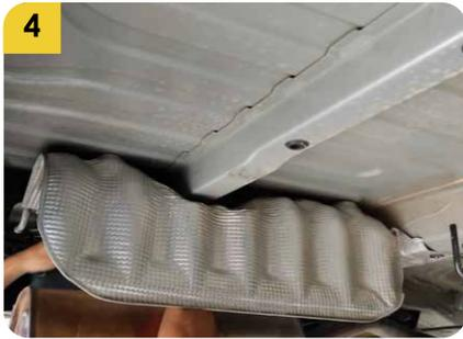
4. Posicionar nuevamente el protector del calor y el mofle en sus posiciones originales.
