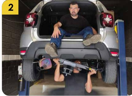
2. Con el repuesto de llanta desmontado en la versión 4X2 proceder con la ayuda de una persona a ubicar los elementos **G** y **J** para instalar el tiro de arrastre.
