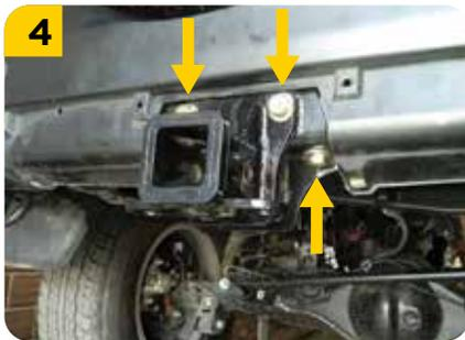
4. Colocar los tornillos (**F**) sin apretar, con sus respectivas arandelas (**G**) y guasas (**H**), para unir el **tiro de arrastre** con el **chasis**.
