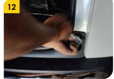
12. Retirar los puntos de anclaje ubicados a cada lado del bumper. y que aparecen luego de abrir la puerta de la cajuela en la zona inferior.
