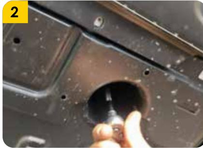
2. Es necesario retirar todos los tornillos de anclaje de la tapa señalada anteriormente.
