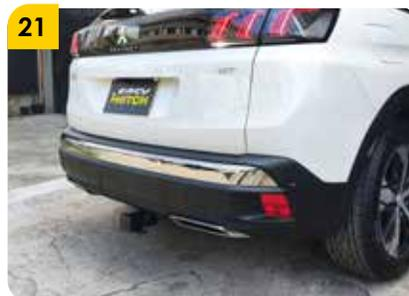
**21.** El tiro de arrastre queda instalado, si de desea instalar el portabola **(B)**, asegurar con pasador **(C)** y pin de seguridad **(D)**, y apretar la bola **(B)**. Para evitar vibraciones en el Porta bola **(B)** apretar el tornillo **(E)** levemente para evitar vibraciones
