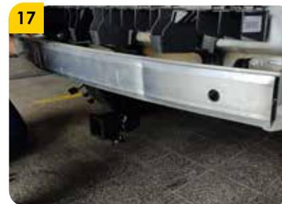
17. Ubicar el tiro entre el alma bumper y la carrocería y proceder a fijar con la tornillería correspondiente.
