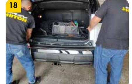
18. Ubicar el bumper plástico en una posición cercana en la cual quedará instalado.
