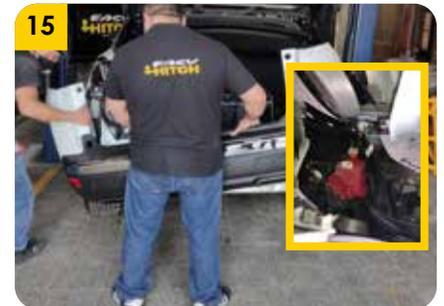
15. Mientras una persona sostiene el bumper la otra persona debe proceder a realizar la desconexión final de los sensores relacionados para que se pueda retirar en su totalidad el bumper.
