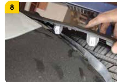
8. Al ir desacoplando los pines se puede proceder a retirar la tapas plasticas laterales.
