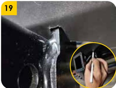
**19.** Proceder a realizar el trazado del corte necesario para realizar el respectivo corte.
