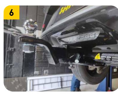
6. Posicionar el tornillo prisionero (F) y apretar levemente para evitar vibraciones en el portabola.
