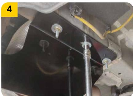
4. Retirar las pescas con la precaución de evitar que los tornillos ingresen al interior de la carrocería y proceder a realizar el apriete de los elementos de sujeción restantes como lo son arandelas (I) y tuercas (J).
