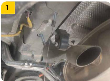
1. Realizar la técnica de pesca en ambos lados de la carrocería del vehículo, se deben ubicar 3 tornillos (G) con sus respectivas placas (H) y pescas (K).
