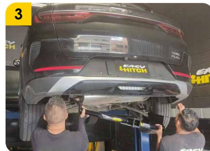
3. Ingresar las pescas a través de las perforaciones de las placas del tiro de arrastre para ubicar el tiro en la carrocería del vehículo.
