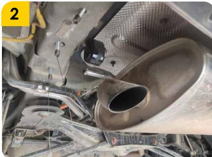
2. Retirar los cauchos de sujeción del tanque del mofle, durante la instalación el tanque debe permanecer suspendido.
