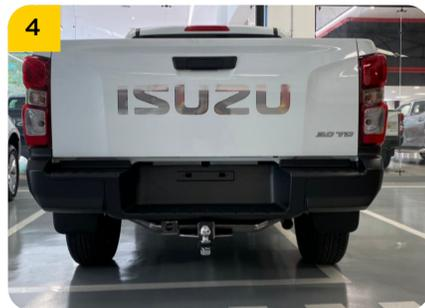
4. Colocar el portabola (B), asegurar con pasador (D) y pin de seguridad (E), y apretar la bola (C) con un torque de 250 ft/lb. Para evitar vibraciones en el portabola (B) apretar el tornillo (F) con un torque leve para evitar vibraciones.
