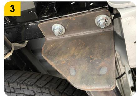
3. Apretar firmemente los tornillos (G) en ambos lados con un torque de 70 ft/lbs.
