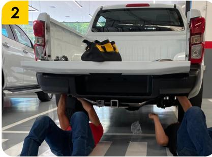
2. Acoplar el tiro de arrastre en el chasis con la precaución de que algún elemento ingrese al interior del chasis.
